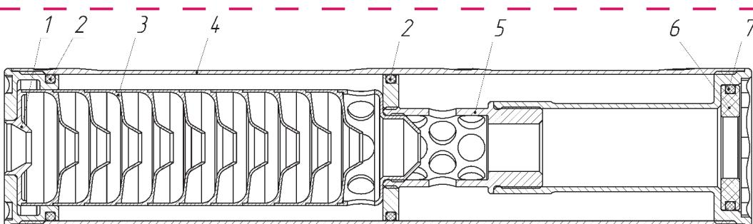
Рис. 1 – Конструкция ПБС Jäger 1.0
